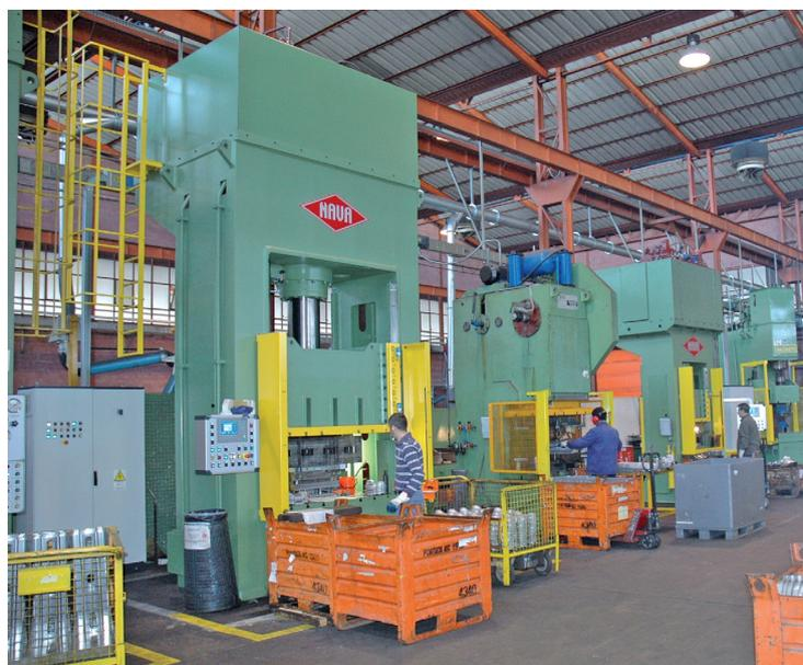
Fase di lavorazione su pressa Nava di un componente automotive imbutito in lamiera di acciaio inox.
