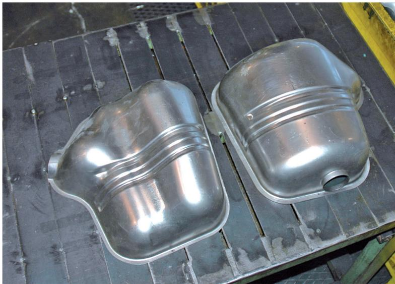
Serie di manufatti in lamiera di acciaio inox realizzati per il settore motoristico.
